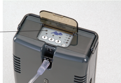
Abb. 15: Anzeige für erforderliche Inspektion/Wartung
