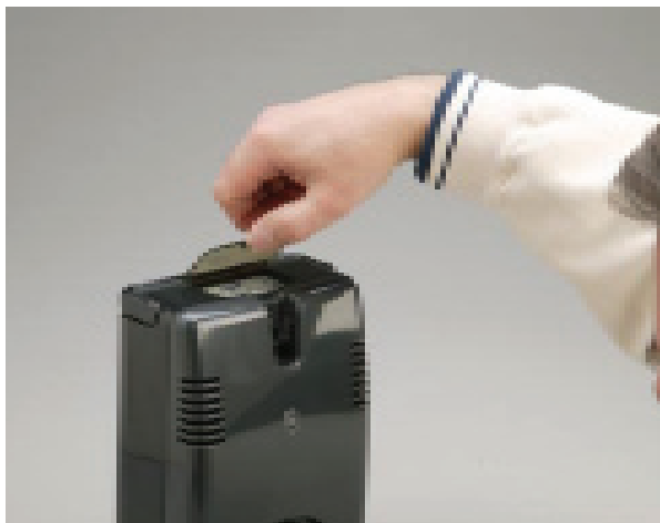
Abb. 13: Staubschutz über Bedienfläche öffnen
